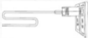
Conecte el extremo del cargador magnético con los puntos de contacto USB, asegurando que queden ajustados. El indicador de la lámpara se volverá rojo lo que significa que está cargando.
